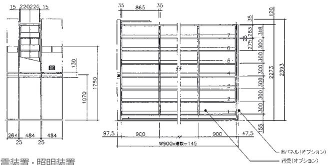
●オプション：Bパネル 外形寸法Wは+7mm ●オプション：免震装置・照明装置
