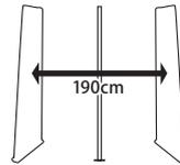
●システム用電源は、電源より入るノイズを軽減するためにできるかぎり専用電源を設けてください。(容量: AC100V/アース付 max3A/システム) ●パネル側面より70cm以内に金属製の書架、看板等を置かないでください。検知用磁場が乱されて、タグの検出ができなくなる場合があります。(木・プラスチック製のものは影響を受けません。) ●コンクリートの壁面からも同様の理由で40cm以上離してください。 ●ノイズ発生源となるTV、パソコン等のCRTを近くで使用しますと画面が揺れますので、できるかぎりパネルより離すようにしてください。
